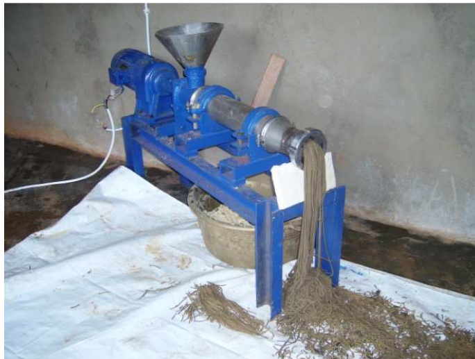
Figure: Fabrication d'un aliment granulé pour poissons à l'aide d'une boudineuse.
